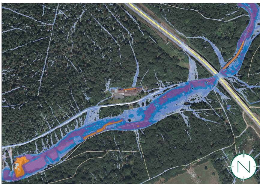
Örtliches Schutzkonzept zum Schutz der Stadt Merzig vor Starkregen und Hochwasser; Quelle: Ingenieurbüro eepi GmbH und geoportal.saarland.de; Stand: November 2023
