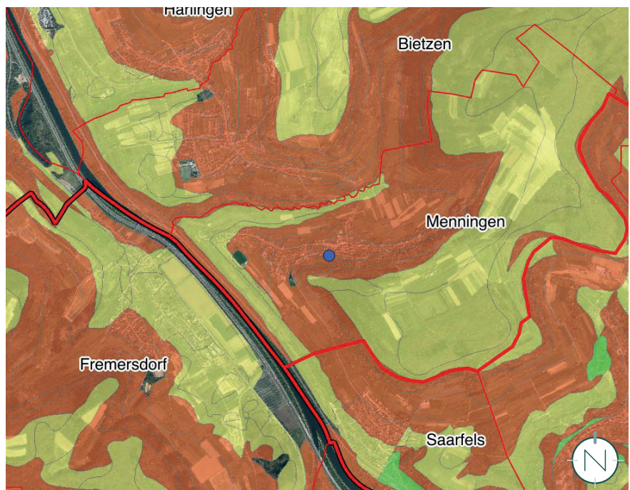
Versickerungsfähigkeit des Bodens (blau = Plangebiet, grün = geeignet, gelb = bedingt geeignet, rot = ungeeignet); Quelle: LVGL, GeoPortal Saarland, Stand der Abfrage: 15.04.2021)
